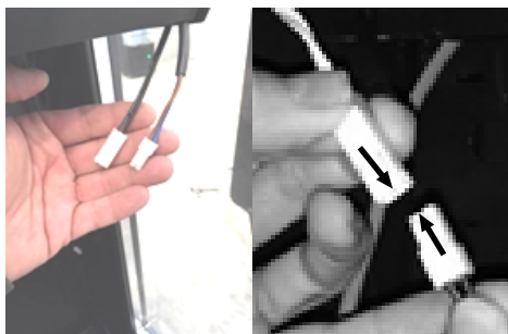
Abb. 8: Kabel verbinden LED-Balken
