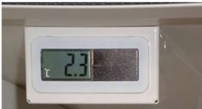
Sl. 3: Prikaz unutarnje temperature Prikaz: solarni ili baterijski pogon
