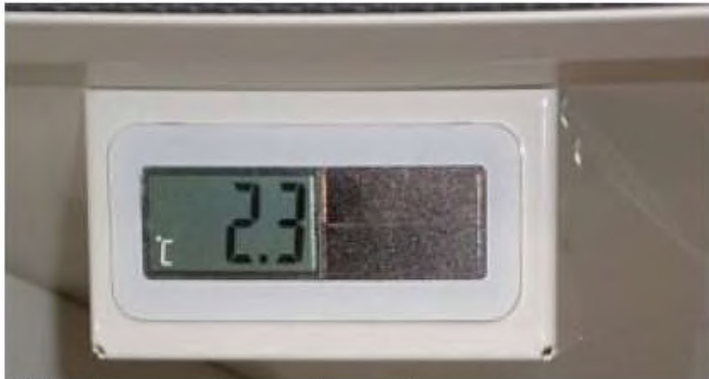
Фиг. 3: Индикатор на вътрешната температура Показание: Работа с батерия - соларна и обикновена
