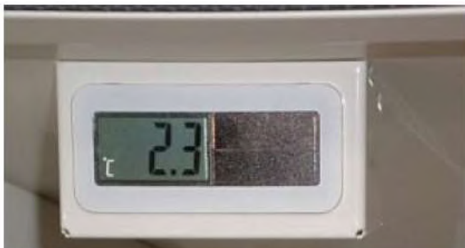
3. att.: Iekšējā nodalījuma temperatūras indikators Indikators: Solārais vai bateriju režīms
