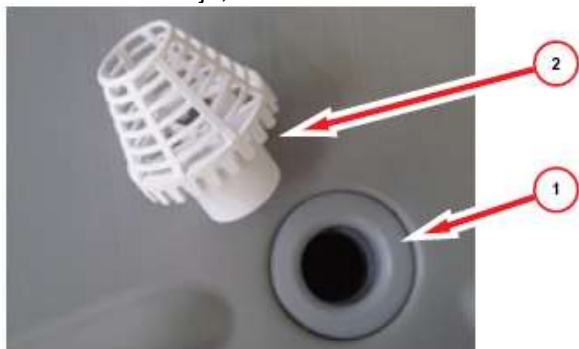
Sl. 13. Odtok (1) z odtočnim sitom (2)
