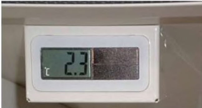
Fig. 3: Indicação de temperatura interior Indicação: funcionamento a energia solar ou a bateria
