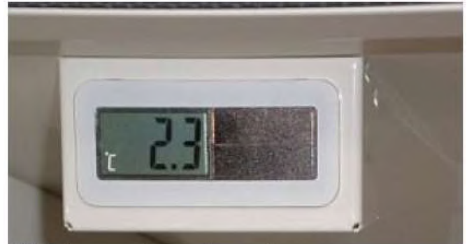
Fig. 3: Indicación de la temperatura interior Indicación: Servicio solar o de batería
