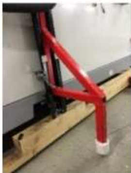
Obr. 7: Zajištění proti překlopení
