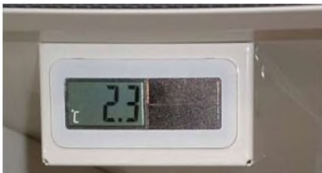
Εικ. 3: Ένδειξη θερμοκρασίας εσωτερικού χώρου Ένδειξη: Λειτουργία με ηλιακή ενέργεια ή μπαταρία
