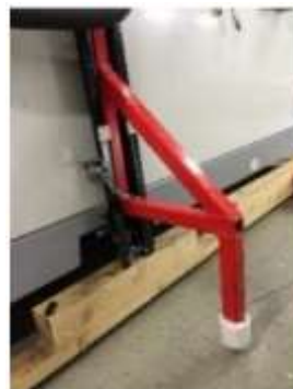
Rys. 7: Zabezpieczenie przed przewróceniem
